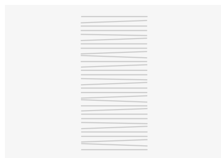
Ziehen, Stossen oder Zurückhalten des Stoffes verursachen unregelmässige Stichfolgen
